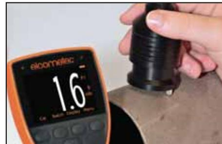
Alle Elcometer 224 oppervlakprofielsondes hebben een nauwkeurigheid van  $\pm 5\%$  of  $\pm 5 \mu\text{m}$  ( $\pm 0,2 \text{ mil}$ ) en zijn voorzien van een glazen nulplaat, kalibratietestfolies – nominale waarden  $125 \mu\text{m}$  ( $5,0 \text{ mil}$ ) &  $508 \mu\text{m}$  ( $20 \text{ mil}$ ) en een Elcometer testcertificaat.
