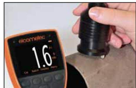
Elcometer 224のプローブはどれも測定精度が±5%または±5µm (±0.2mil) で、ゼロ値設定用ガラス板、公称値125µm (5.0mil) と508µm (20mil) の校正用フォイル、Elcometer検査証明書が付属しています。
