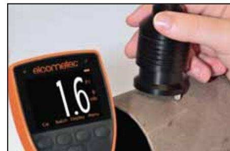
Toutes les sondes de profil de surface de l'Elcometer 224 ont une précision de  $\pm 5\%$  ou  $\pm 5\mu\text{m}$  ( $\pm 0.2\text{mil}$ ); elles sont livrées avec une plaque zéro en verre, des cales étalon - valeurs nominales  $125\mu\text{m}$  ( $5.0\text{mils}$ ) &  $508\mu\text{m}$  ( $20\text{mils}$ ) - et un certificat de test Elcometer.
