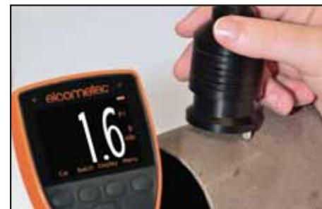
Todas las sondas de perfil de superficie Elcometer 224 ofrecen una precisión de  $\pm 5\%$  o  $\pm 5\text{ }\mu\text{m}$  ( $\pm 0,2$  mil) y se suministran con una placa de vidrio cero, láminas de prueba de calibración, valores nominales de 125  $\mu\text{m}$  (5,0 mils) y 508  $\mu\text{m}$  (20 mils) y un certificado de prueba de Elcometer.
