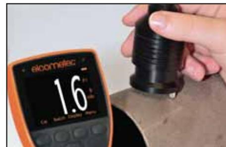
所有Elcometer 224表面粗糙度探头的精度均为 $\pm 5\%$ 或 $\pm 5\mu\text{m}$ ( $\pm 0.2\text{mil}$ )，并配有玻璃调零板,校准测试膜片;标称值 $125\mu\text{m}$ ( $5.0\text{mils}$ )和 $508\mu\text{m}$ ( $20\text{mils}$ )，以及易高测试证书。
