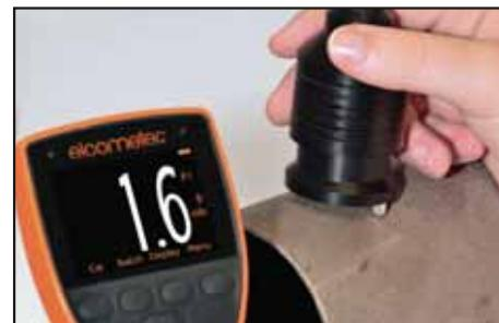
Alle Elcometer 224 Oberflächenprofilsonden haben eine Genauigkeit von  $\pm 5\%$  bzw.  $\pm 5 \mu\text{m}$  ( $\pm 0,2 \text{ mil}$ ) und werden mit einer Glas-Nullplatte, Kalibriertestfolien mit den Nennwerten  $125 \mu\text{m}$  ( $5,0 \text{ mil}$ ) und  $508 \mu\text{m}$  ( $20 \text{ mil}$ ) und einem Elcometer-Prüfzertifikat geliefert.
